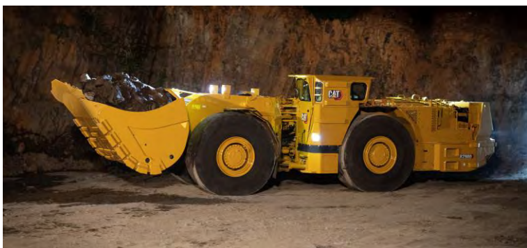
Fig. 48 Makina ngarkuese-transportuese me naftë për miniera nëntokësore
