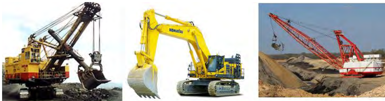
Fig. 44 Ekskavator me kovë me litar, ekskavator hidraulik me kovë dhe ekskavator me draglinë për minierat sipërfaqësore
