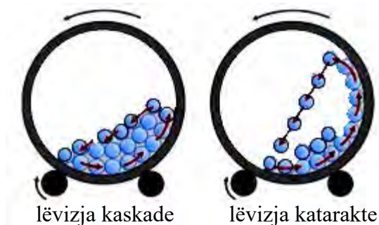
Fig. 73 Lëvizja e kataraktit dhe kaskadës së trupave të mullirit.
