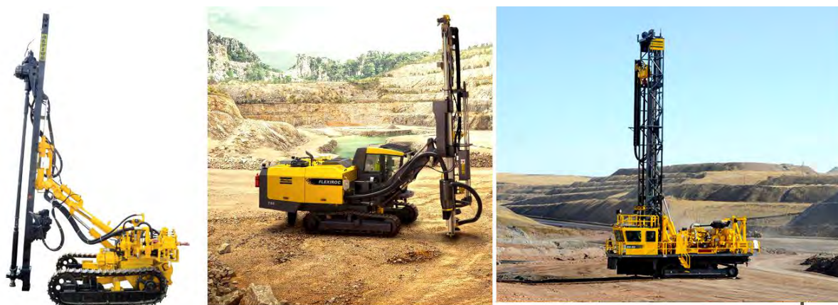
Fig. 43 Shpuarëse për shpimin e vrimave të gjata të minave në miniera sipërfaqësore
