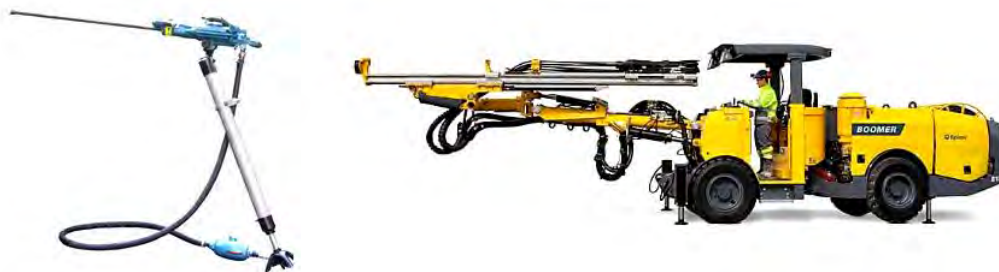
Fig. 46 Shpuarëset e dorës dhe shpuarëset e mekanizuara për minierat nëntokësore
